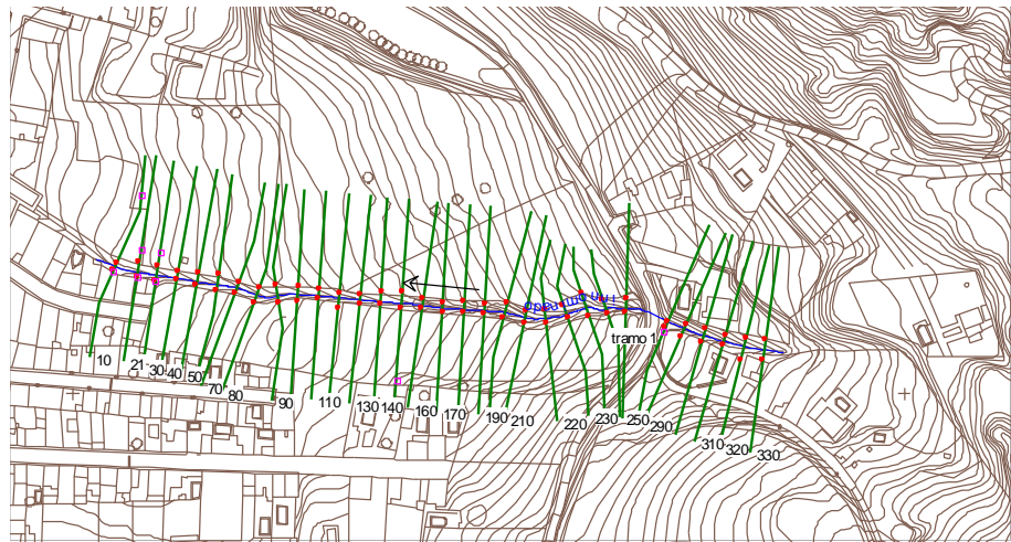
Ilustración 1. Esquema del Modelo Hidráulico del Arroyo innominado
