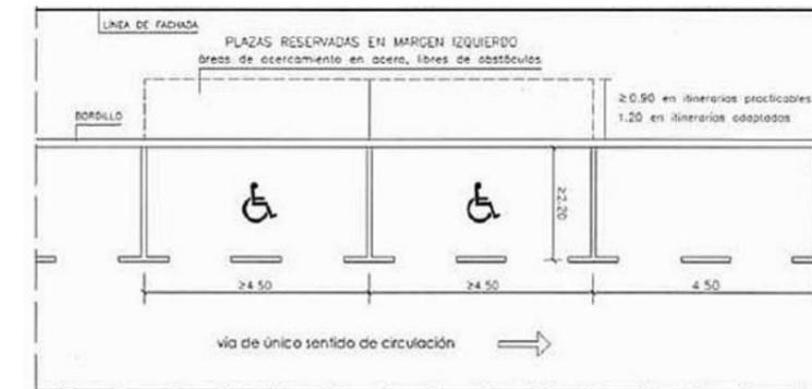
Ilustración 26 Diseño de áreas de estacionamiento en batería para personas discapacitadas (1)
