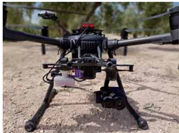
Figura1: A la izquierda se muestra el dron equipado con una cámara RGB y un sensor multispectral. A la derecha puede verse el mismo dron montando una cámara termográfica y un sensor multispectral.
