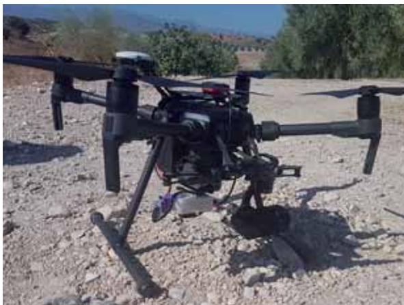
Figura1: A la izquierda se muestra el dron equipado con una cámara RGB y un sensor multispectral. A la derecha puede verse el mismo dron montando una cámara termográfica y un sensor multispectral.
