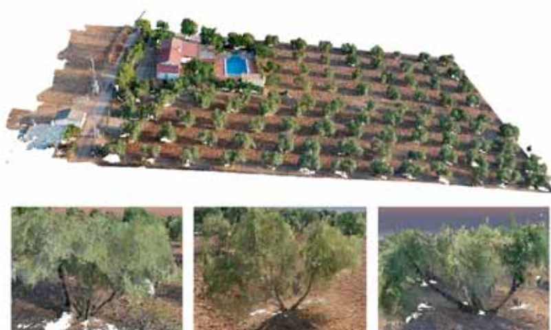
Figura 3: Modelo 3D fotogramétrico correspondiente a una parcela de olivar ubicada en la localidad de Marmolejo (Jaén). En la parte inferior se muestran tres plantas de olivar en las que se puede ver con mayor detalle la reconstrucción tanto de la parte del tronco como de la copa del árbol.
