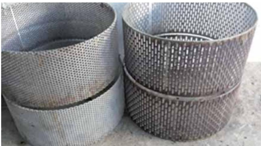
Figura 2. Cribas elípticas y circular utilizadas en la investigación.
