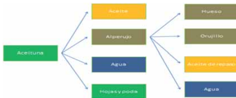
Ilustración 1. Esquema de productos y subproductos de la extracción del aceite de oliva.
