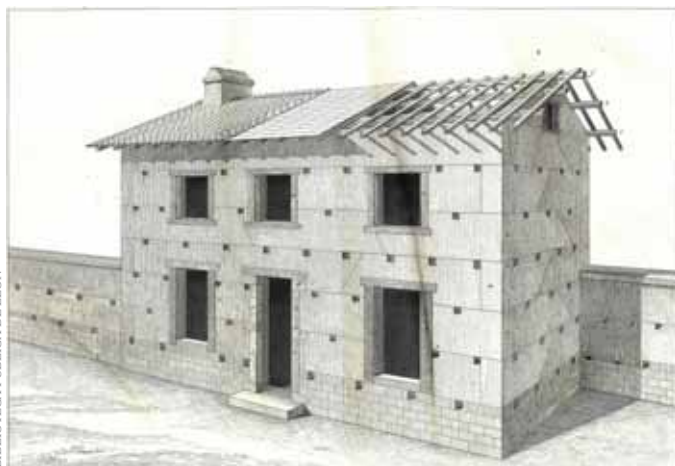
La técnica del tapial según Jean Rondelet en su Traité de l'Art de Bâtir (Tratado del arte de construir). París, 1800.
