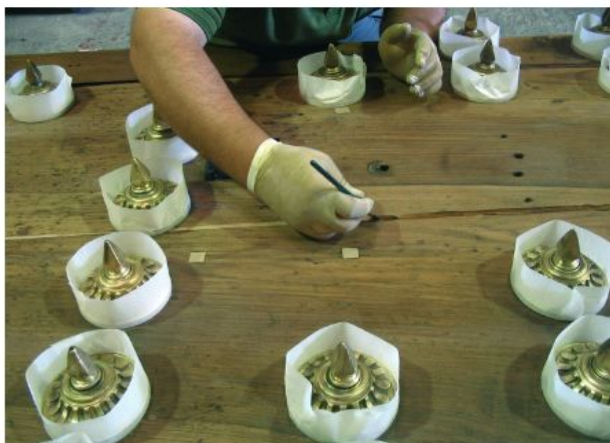
Tras proteger adecuadamente la clavazón, este artesano procede a entintar las partes nuevas.
