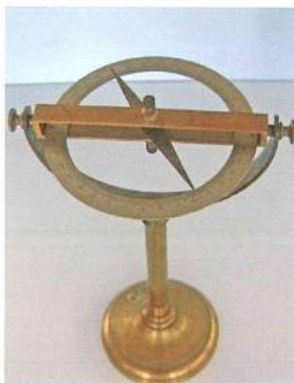
Medida de la inclinación: se coloca el limbo graduado según el plano meridiano que pasa por el lugar, de forma que las dos divisiones que lleva el círculo con las marcas 0° - 0° apunten al Norte; la aguja magnética, debido al campo magnético de la Tierra, quedará desviada de la horizontal un cierto ángulo, llamado *inclinación magnética*.
